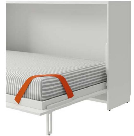
Los tiradores integrados funcionan a su vez como pata en las camas individuales y en las inferiores. Bajan automáticamente por gravedad y disponen de un sistema oculto de bloqueo que impide que se plieguen involuntariamente cuando están apoyadas en el suelo. Se pueden nivelar para asegurar un correcto asentamiento.
